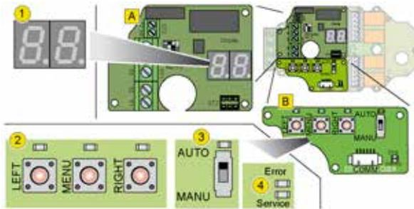
Zwei 7-Segment-Anzeigen (1) informieren über den Reglerstatus und die Bedienschritte. Der Regler wird mit den drei Tasten (2) und dem Schalter (3) konfiguriert und bedient.
