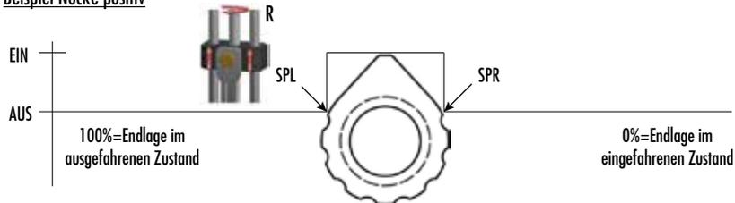
Durch die Definition und Position dieser beiden Schaltpunkte können verschiedene Schaltmuster (Nockenformen) frei definiert werden.
